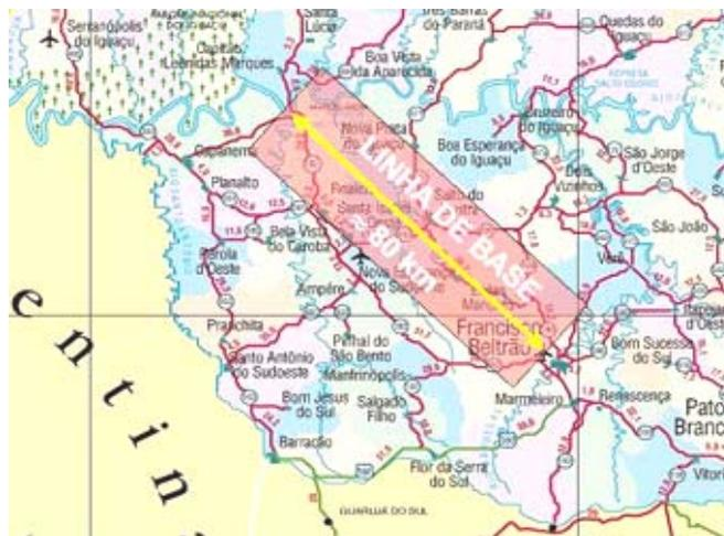
Figura 4 – Linha de base entre o ponto de referência e a rede geodésica de monitoramento
