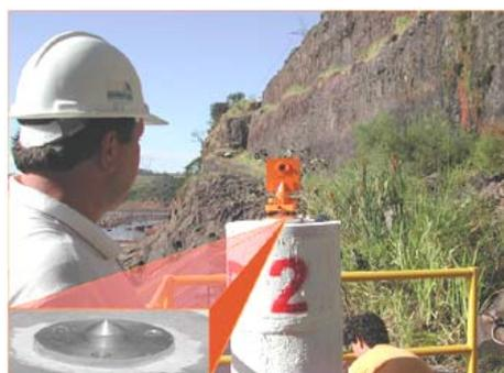
Figura 2 – marcos geodésicos com centragem forçada
