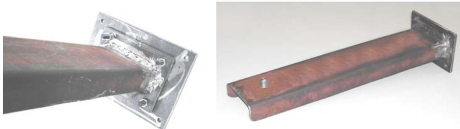
Figura 7 – Dispositivo de Centragem Forçada (DCF)
