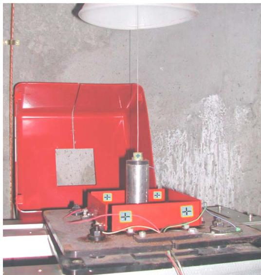
Figura 9 – Pêndulo e fitas refletoras nos pontos de monitoramento
