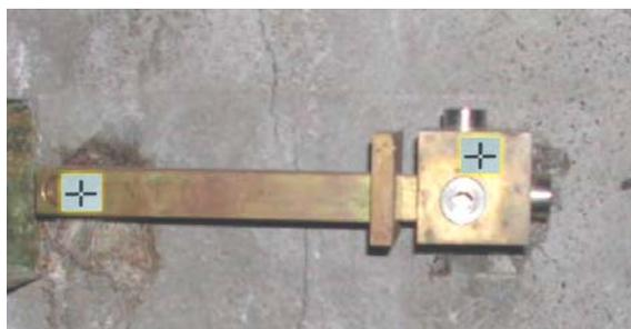
Figura 10 – Extensômetro e fitas refletoras nos pontos de monitoramento
